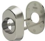
Diese sind aus sehr hartem Chromstahl gefertigt und erschweren oder verhindern ein abwürgen des Zylinderschlosses mit Zangen und dergleichen. Die Sicherheitsrosette wird aussen auf das bestehende Schild aufgesetzt und von innen durch das Türblatt hindurch verschraubt. Die Grösse der Rosette richtet sich nach der Länge des aussen vorstehenden Zylinders. Diese Rosette ist nur durch massiven Angriff mit geeigneten Mitteln zu überwinden!
