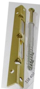
Die Sicherheits-Schliessbleche kommen immer dann zum Einsatz, wenn ein Sicherheits-Einsteckschloss montiert wird. Ohne ein solches macht ein Sicherheits-Einsteckschloss wenig Sinn. An den zu sichernden Türen wird auf der Schlossseite dieses Sicherheits-Schliessblech eingelassen. Durch Verschraubung mit massiven Maueranker durch den bestehenden Holz-Türrahmen, direkt in die gemauerte Wand bietet diese Variante einen optimalen Widerstand gegen gewaltsame Aufbruchversuche.
