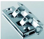
Mindestens zwei solcher Bandseitensicherungen sollten bei gefährdeten Türen auf der Bandseite unsichtbar installiert sein. Die Sicherung und die Verstärkung der Bandseite einer Tür wird vielfach vergessen, ist aber genau so wichtig wie der Schutz der Schlossseite! Mit Krallenartiger Riegelfunktion greifen die Haken automatisch in den Rahmen und verstärken die Scharnierseite massiv.
